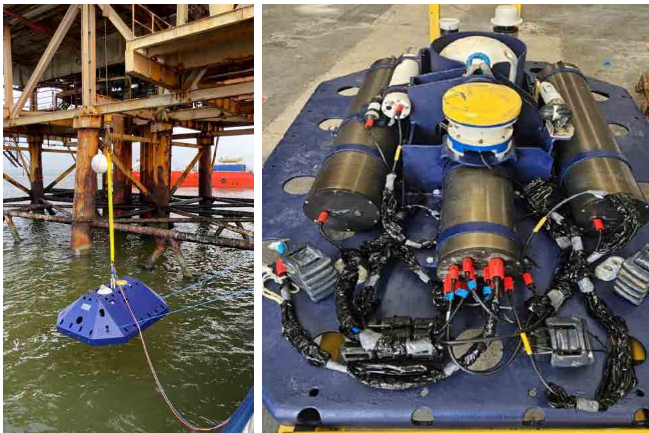
FIGURA 23: LANDER CCS UTILIZZATO PER IL MONITORAGGIO IN CONTINUO A FONDO MARE
