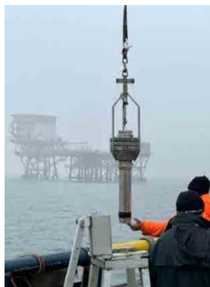
FIGURA 26: OPERAZIONI DI CAMPIONAMENTO DI ACQUE MEDIANTE RETINO BONGO E SEDIMENTI ATTRAVERSO L'UTILIZZO DI BOX-CORER E CAROTIERE A GRAVITÀ SW104 TUBO CORTO
