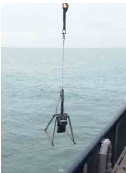
FIGURA 26: OPERAZIONI DI CAMPIONAMENTO DI ACQUE MEDIANTE RETINO BONGO E SEDIMENTI ATTRAVERSO L'UTILIZZO DI BOX-CORER E CAROTIERE A GRAVITÀ SW104 TUBO CORTO
