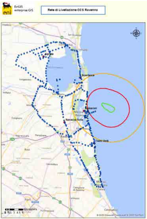
FIGURA 20: POSIZIONE DELLE STAZIONI GNSS IN CONTINUO NELL'AREA DEL PROGETTO (a sinistra) POSIZIONE DEI CAPOSALDI FACENTI PARTE DELLA RETE DI LIVELLAZIONE DI ALTA PRECISIONE (a destra)
