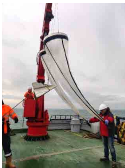
FIGURA 26: OPERAZIONI DI CAMPIONAMENTO DI ACQUE MEDIANTE RETINO BONGO E SEDIMENTI ATTRAVERSO L'UTILIZZO DI BOX-CORER E CAROTIERE A GRAVITÀ SW104 TUBO CORTO
